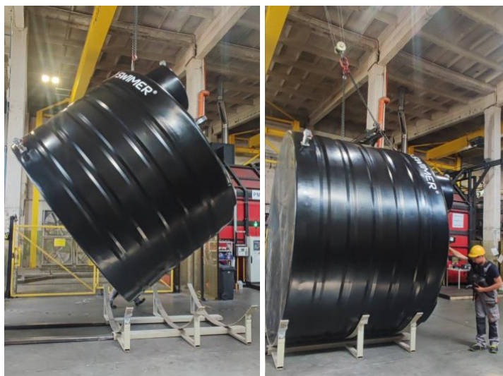
Rys. 7. Ustawianie zbiornika o pojemności 22000 l na kołyszce do transportu w pozycji poziomej
